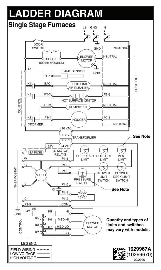
Figure 30. Nordyne/UTEC Ladder Diagram
